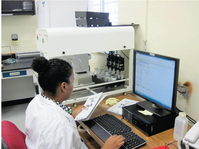
Figura 8. Analizador de  $DBO_5$
