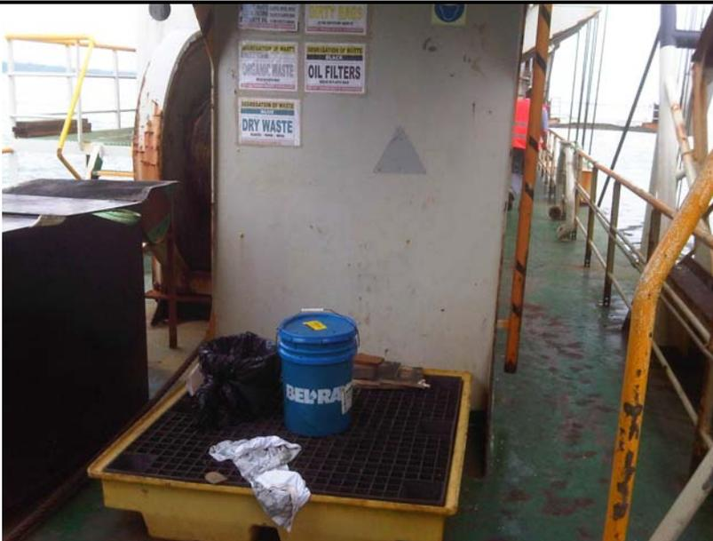
16. Uso de sistemas de contención secundaria para el manejo de sustancias a bordo de la draga Marco Polo. / Use of secondary containment systems for materials management aboard the dredge Marco Polo.
