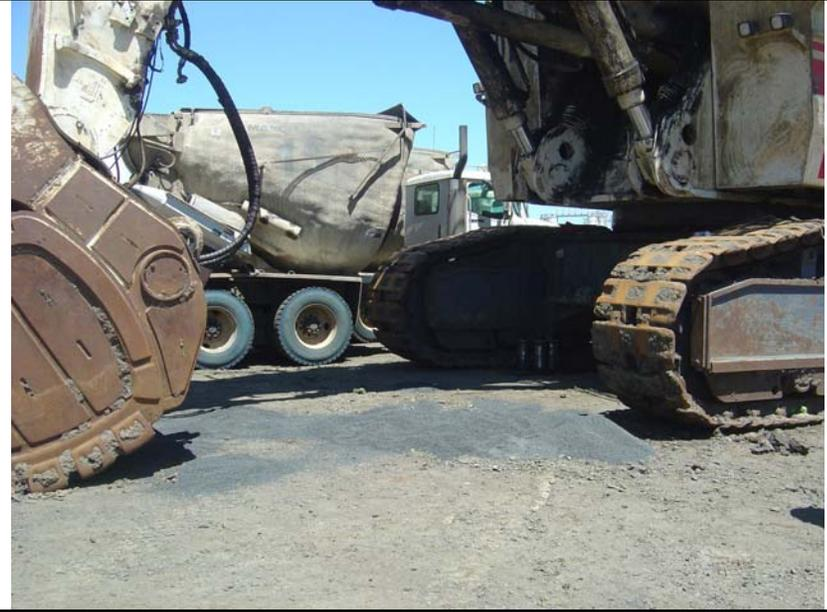
21. Evidencia de trabajos de mantenimiento realizados sobre el suelo desnudo sin elementos (plásticos, bandejas, etc.) para proteger los suelos / Evidence of maintenance work taking place over bare soils without the use of protection (plastic, drip trays, etc.).
