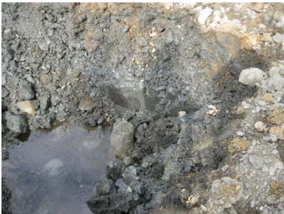
**Foto No. 3:** Calicatas con presencia de hidrocarburos
