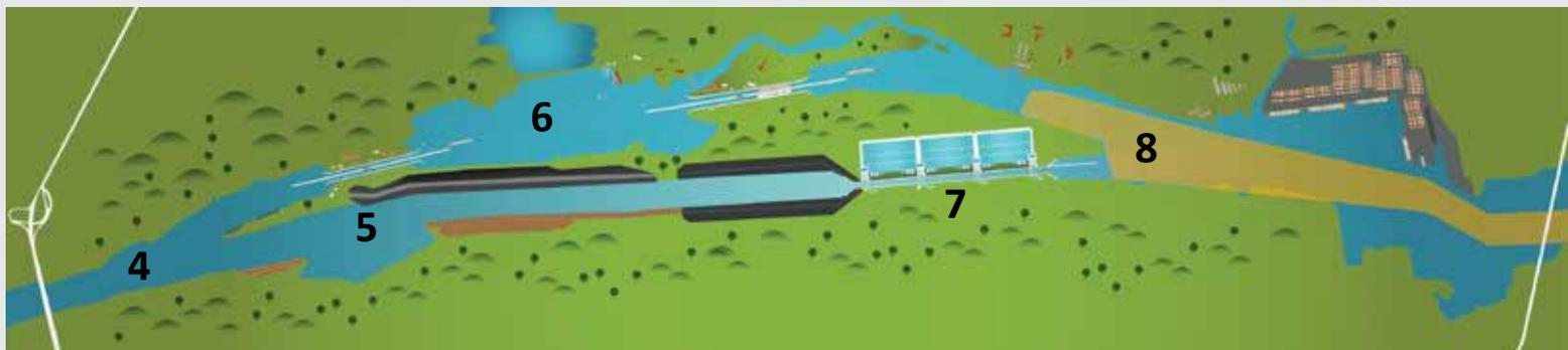
4. Entrada/salida Corte Culebra 5. Cauce de Acceso del Pacífico 6. Lago Miraflores 7. Nuevas esclusas de Cocolí 8. Dragado en la entrada del Pacífico
