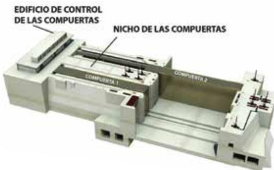
Las nuevas esclusas necesitarán 16 compuertas que serán de tipo rodante. Éstas funcionan desde un nicho anexo y perpendicular a la cámara de la esclusa. Dicha configuración de compuertas hace de cada nicho un dique seco, lo que a su vez, permite darle mantenimiento a la compuerta en su sitio sin que requiera ser removida y sin mayor interrupción del funcionamiento de la esclusa.
