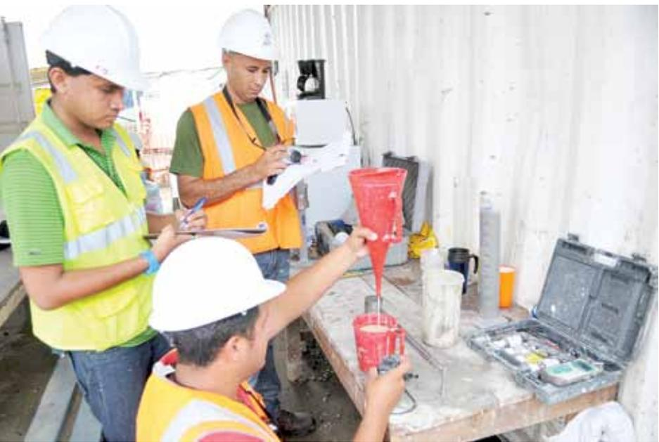
Importada de México, la bentonita, una arcilla de grano muy fino, es mezclada con agua y luego de ser hidratada por un periodo de 24 horas, se combina con el cemento en estas plantas. Como explica el ingeniero Sánchez, la bentonita trabaja como “el autobús del cemento” porque debido a sus características físicas, una vez que es combinada con este material, crea una mezcla que puede vaciarse sin que el cemento se asiente.
