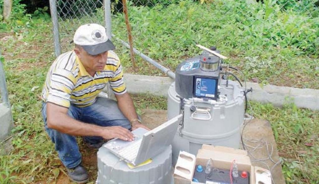
Un técnico hidrológico baja datos de un captador de muestra de agua para medir el caudal del riachuelo.
