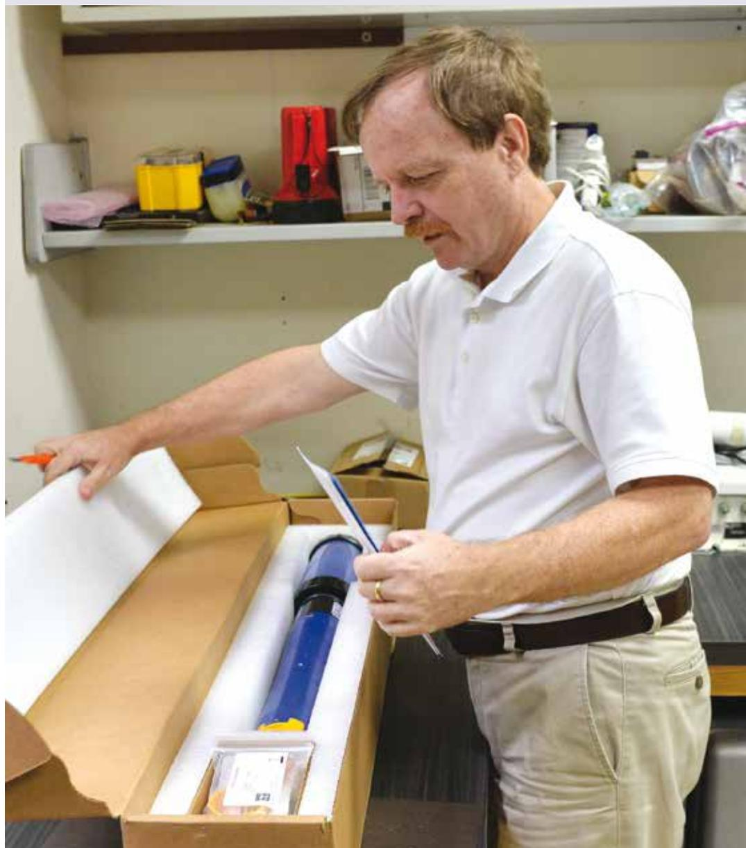
Sonda que se introduce en el agua para medir salinidad, temperatura, oxígeno, clorofila, y Ph (para medir el grado de acidez).
