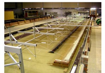
Se concluyó la construcción del modelo del buque portacontenedor de 12000 TEUs a escala 1/80. Sus dimensiones generales son 4.5m eslora y 0.60m manga. Se están haciendo pruebas para la calibración de los sensores y se iniciarán las pruebas a fines de julio de 2007. Durante la primera semana de julio la ACP realizó una visita a las instalaciones en Flanders Hydraulic, en Amberes, Bélgica, para inspeccionar el avance de la construcción del modelo y discutir detalles sobre el diseño del mismo.
