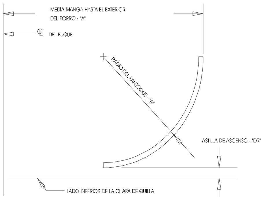
NOTA: En un esclusaje descentrado en que el buque toque el muro de la esclusa, la curvatura del pantoque debe quedar franca de los taludes de las cámaras de las esclusas en el punto más crítico, tal como se ilustra en la Tabla de Límites de Calado en este anexo.
